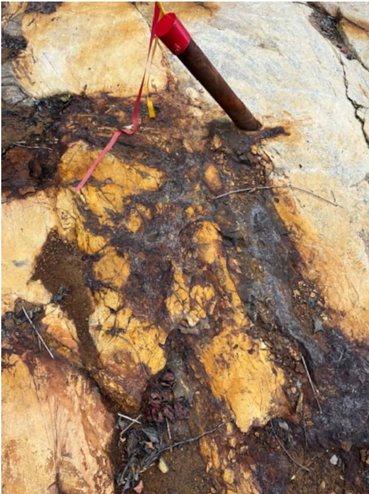
Écoulement d'acide sulfurique sur le site d'un forage dans Lanaudière. Photo Benoit Laporte Benoit Laporte
